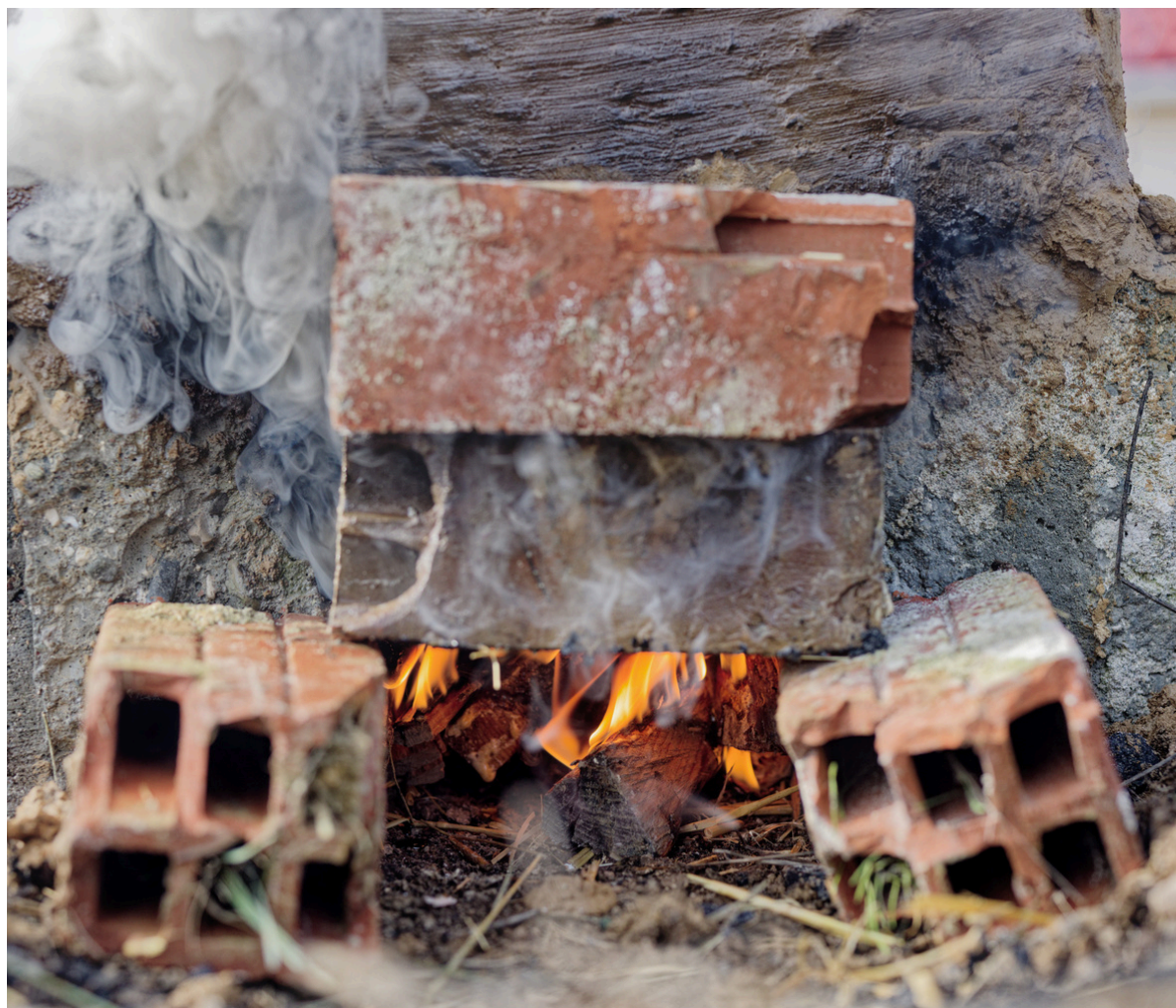
Στιγμιότυπο από το εργαστήριο κατασκευής ασβεστοκάμινου και παραγωγής ασβέστη με την τεχνικές quicklime του προγράμματος ΚΕΡΕΤΣΙ Μαθητεία και Εργαστήριο για τα Κονιάματα στην Παραδοσιακή και Αειφόρο Δόμηση Φωτ. Ιάσωνας Αθανασιάδης
